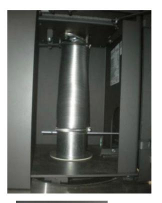
Bedienungshebel Frischluftklappe Operation lever fresh air valveflap Betjeningshåndtag frisk luft ventilklap
